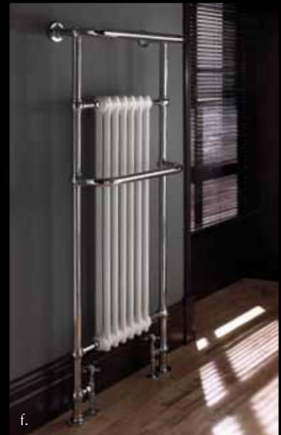
f. Malmo 6 bar 1500 White** h1500 w584 d225mm 2728 BTU Available in Chrome/White
